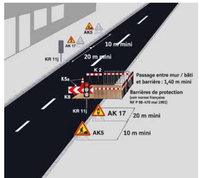
ALTERNAT PAR FEUX EN VOIE URBAINE
