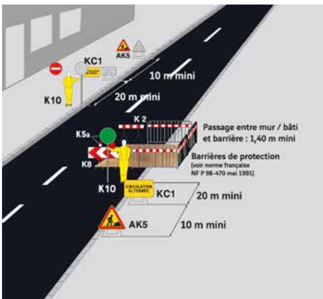
ALTERNAT PAR PIQUETS EN VOIE URBAINE
