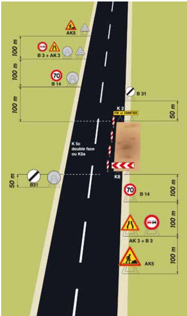
FORT EMPIÈTEMENT SUR ROUTE À 2 VOIES
